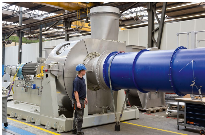
Prueba de rendimiento en el banco de ensayos de tuberías
